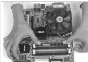
3. Push the module till the clips snap back
